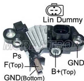
333357 feszültség szabályzó 14V/13,8V, adatátvitel:4byte Bosch:0125 711 001,-102,-103
