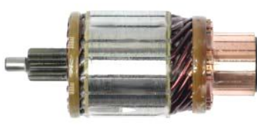
32-203-105 indító forgórész 12V/1.5kW, hsz: 19 cw, Ø50x118,8mm Valeo: D 7G 3,-4,-6,-7,-17
